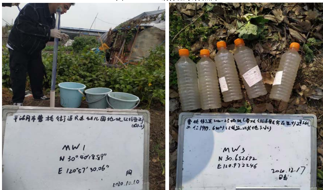
图 5.3-1b 地下水洗井及采样照片
